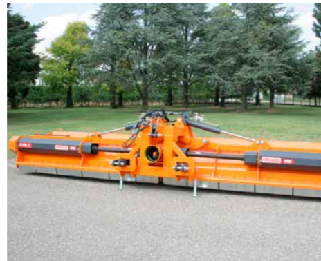
Гідравлічно-складна рама. Ширина в складеному стані: 2 473 мм
