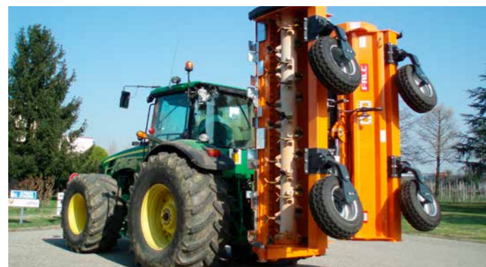
Гідравлічно-складна рама. Ширина в складеному стані: 2 473 мм
